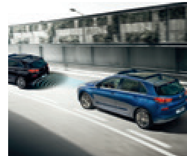
Az adaptív sebességtartó automatika (ASCC) automatikusan tartja az előre beállított távolságot az elől haladó jármű mögött, szükség szerint lassítva vagy gyorsítva.
